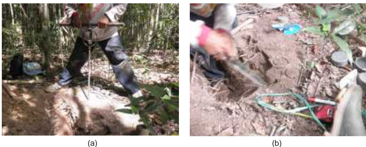
Gambar 4. Contoh pengukuran tahanan penetrasi tanah menggunakan penetrometer (a) dan pengambilan contoh tanah menggunakan soil sampler rings (b)
